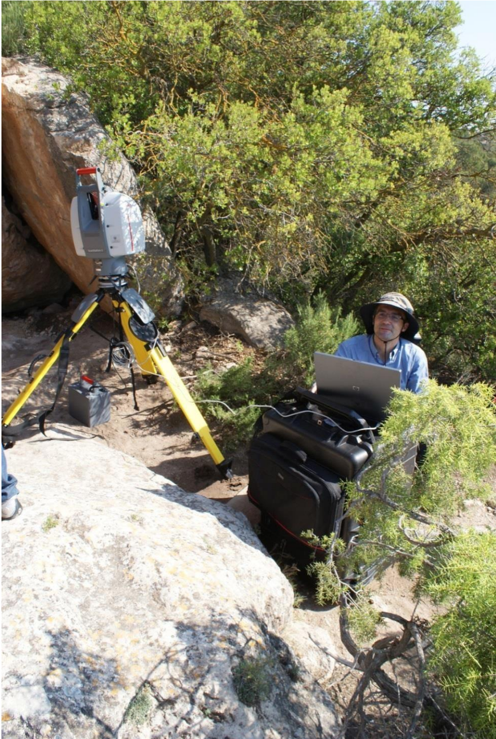
Figura 14 Trabajo de documentación pintura rupestre Cantos de Visera. Barrido laser. (Fotografía MAYE)
